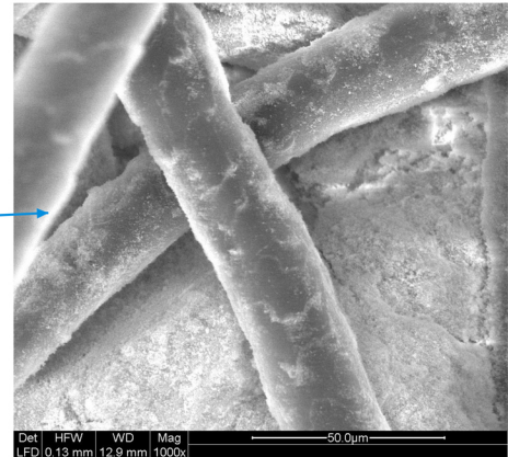
Imprägnierter Filz · REM \times 1000
