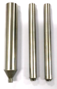
Werkzeuge für das Bohrungsschleifen.
