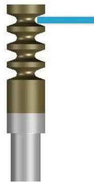
Notch-Werkzeug mit dargestellter Kontaktposition.
