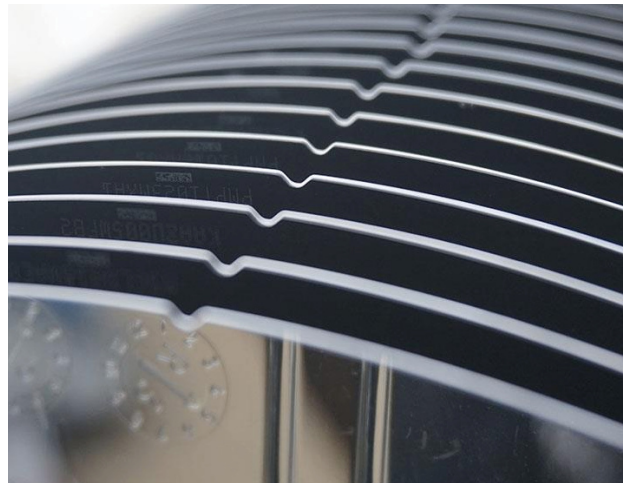
Waferkanten mit Notches im Anwendungsbild.
