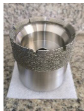
Werkzeugausführung für Tap Grinding.
