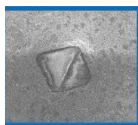
EHWA-BSL-Scheibe nach 60 h: zweite Aufnahme ohne beobachteten Diamantverlust.
