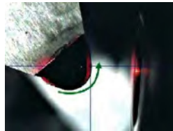
Schneidenprüfung bei 500-facher Vergrößerung.
