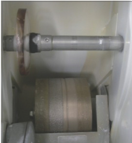
Werkzeugeingriff beim optischen Linsenschleifen.
