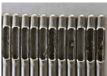
Nadelspitzen nach konventionellem Schleifen: Grate im Vergleichsbild.
