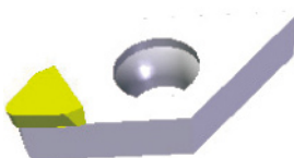
Diamanteinsatz für das Kontaktlinsenwerkzeug.
