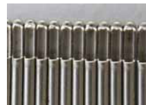
Nadelspitzen nach ECG-Schleifen: gratfreies Vergleichsbild.
