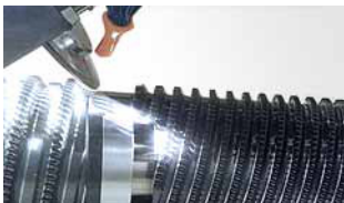
Bearbeitungsbeispiel eines Räumwerkzeugs.
