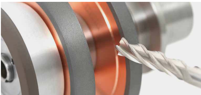
Werkzeugschleifen eines Rotationswerkzeugs mit Schleifscheibenpaket.
