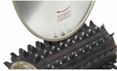
Bearbeitungsbeispiel eines Wälzfräasers.
