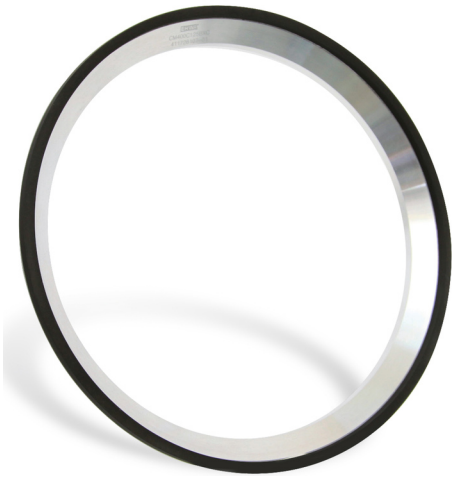
Hybrid-Schleifscheibe für den Umfang von Schneidplatten
