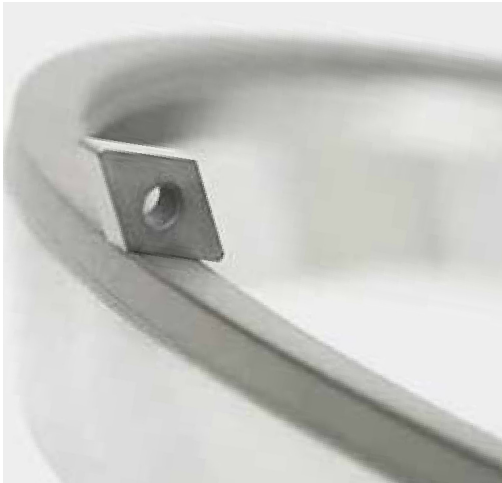
PKD-/PCBN-Schneidplatte im Schleifkontakt
