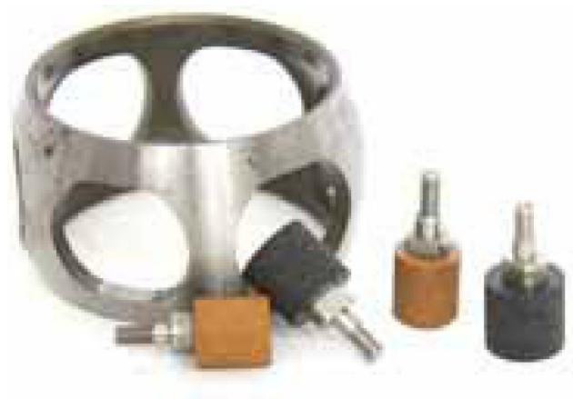
Käfig und Werkzeuge für das Schleifen der Käfigfenster.
