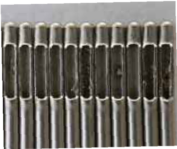
Oberflächenvergleich: konventionelle Scheibe, Grat sichtbar
