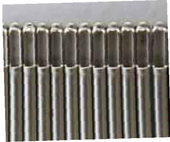
Oberflächenvergleich: EHWA-ECG-Scheibe, gratfreies Beispiel
