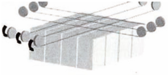
Squaring: Drahtführung und Werkstückanordnung mit Rollen.
