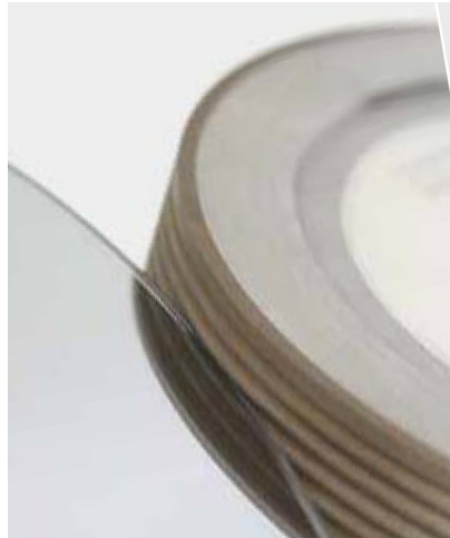
Metallgebundenes Profilwerkzeug für Seitenspiegelglas.
