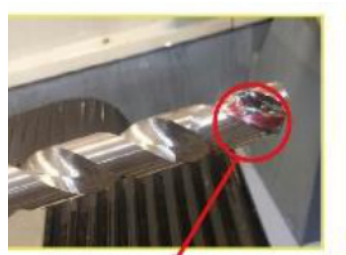
Polierter Werkzeugbereich mit ursprünglicher Positionsmarkierung.
