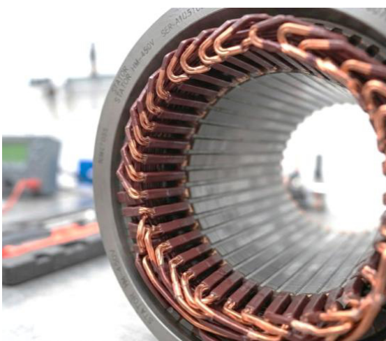
Motorstator mit Hairpin-Wicklung als Bauteilbeispiel.
