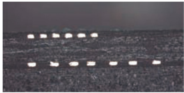
Verbesserte Gehäuseschnittqualität, Originalaufnahme aus Micro-Blade.
