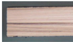
Seitliche und rückseitige Schnittqualität, Originalaufnahme aus Dicing Blade.
