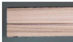
Seitliche und rückseitige Schnittqualität, Originalaufnahme aus Dicing Blade New.
