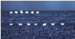
Konventionelle Gehäuseschnittqualität, Originalaufnahme aus Micro-Blade 2018.
