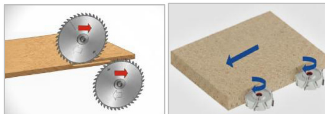
A/T-Fräser bei der Kantenvorbereitung.
