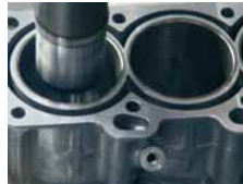
Zylinderblock aus Gusseisen: Bauteil- und Bearbeitungsansicht.
