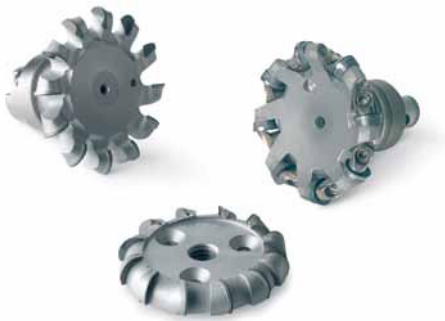
Optische Linsen: Vor- und Feinbearbeitung: Werkzeugansicht.
