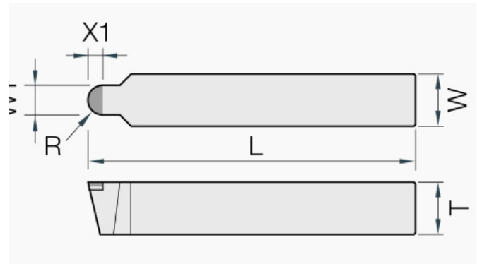
Sonderform: beide ursprünglichen Werkzeugansichten mit ihren Maßbezügen.
