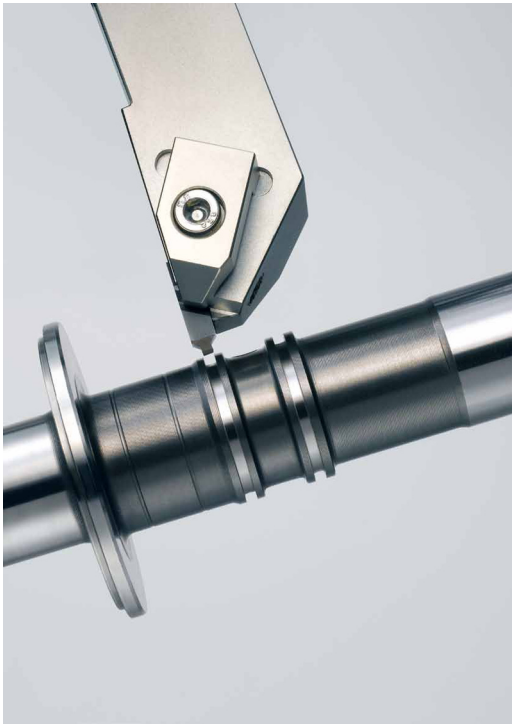
Ein- und Abstechen: Bauteil- und Bearbeitungsansicht.
