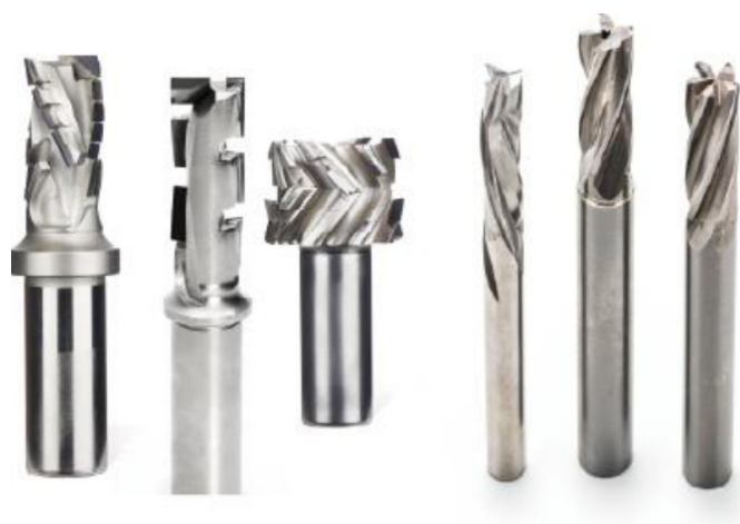
PCD-/TCT-Oberfräser in verschiedenen Formen.
