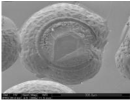
Galvanische Bindung: Diamantverlust.
