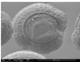
Galvanische Bindung: dargestellter Diamantverlust.
