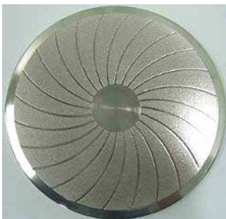
Konventionelle Diamant-Konditionierscheibe im CVD-Vergleich.
