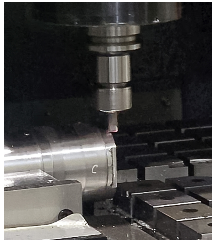
Werkzeugeingriff bei der Zerspanung.
