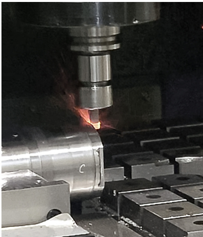
Keramik-Schaftfräser bei der Bauteilbearbeitung.
